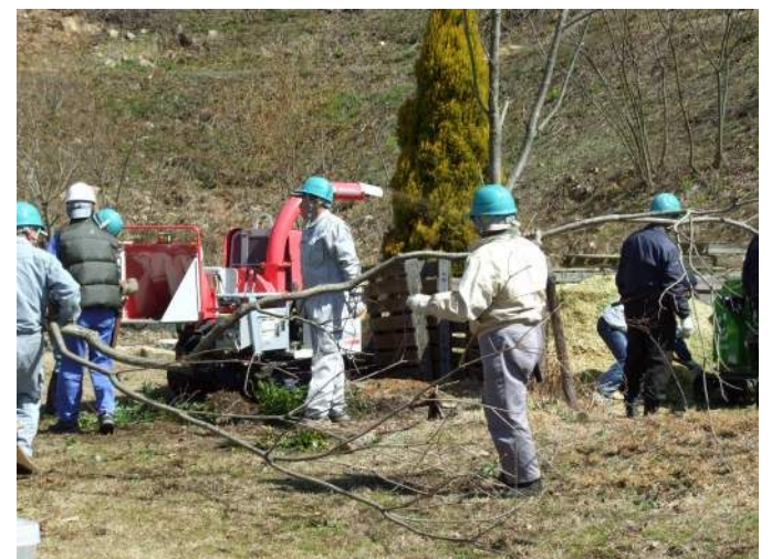
山から下ろした、除伐材は、シュレッダーを使い、ウッドチップにする
