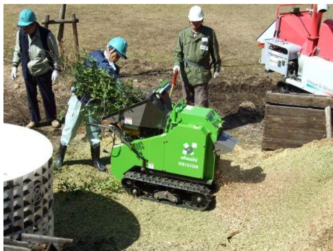
2台のチップーシュレッダーがフル稼働してチップに、太い材は薪になります。
